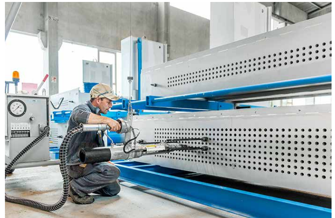
Exemple de technologie de précontrainte avec P_o jusqu'à 10 600 kN (1060 t).
