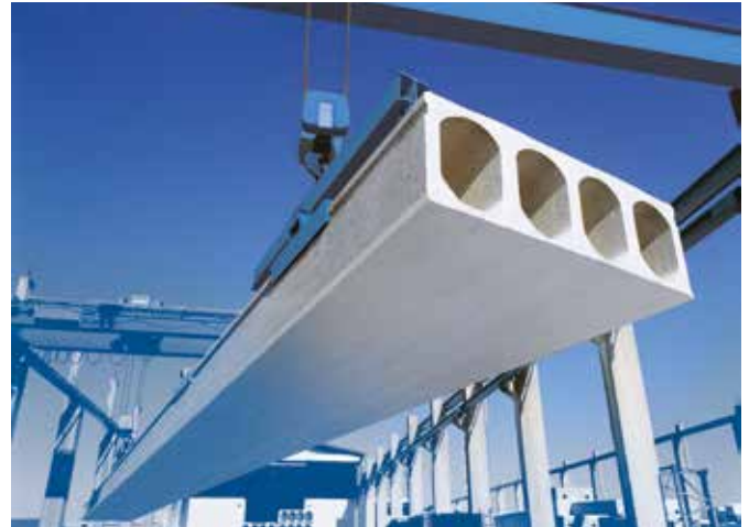
Vorgespannte Hohlzielendecke bereit zum Verlad
