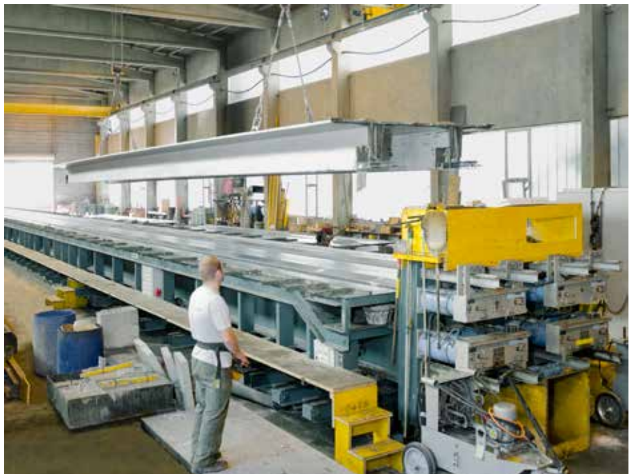
Produktionsstrasse für vorgespannte Parkdecken.
