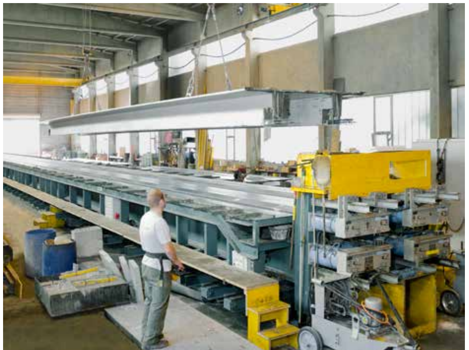
Produktionsstrasse für vorgespannte Parkdecken.
