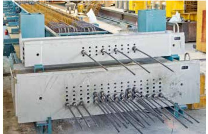
Technologiebeispiel Vorspannung mit P<sub>s</sub> bis 10 600 kN (1060 t).
