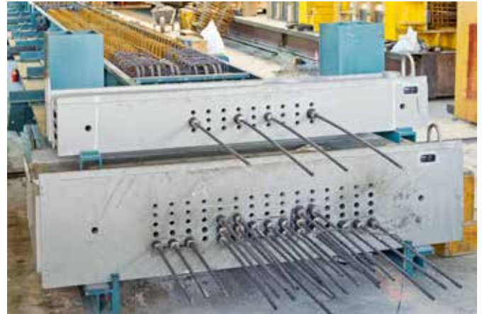
Technologiebeispiel Vorspannung mit P s bis 10 600 kN (1060 t).
