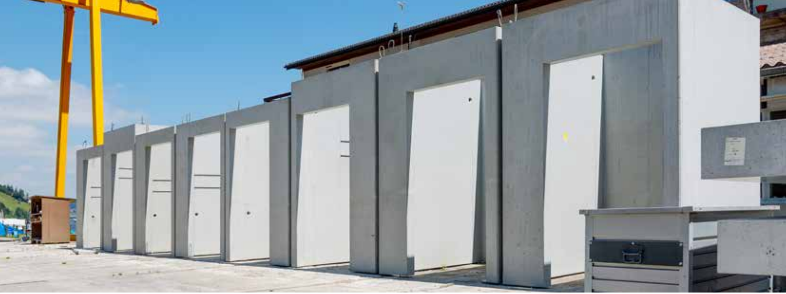
Die vorgefertigten Liftschachtelemente stehen im Werk für den Lieferabruf bereit.
